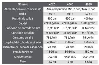
Los valores indicados en la tabla se basan en los siguientes parámetros: grasa de litio NLGIO – presión de aire comprimido 8 bar – salida libre
