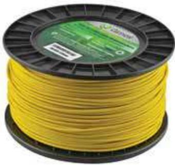
Recubrimiento fabricado con el proceso de co-extrusión, caracterizado por la unión de dos distintas resinas que dan una nueva acción radical; el centro da flexibilidad y amortización y la cubierta para corte la hace resistente a la abrasión y a la fricción. La dos resinas de alto grado mezcladas en una sola línea dan una óptima confiabilidad.
